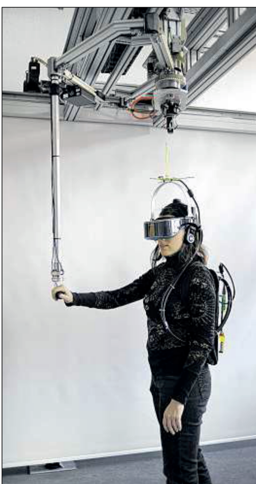
LÄUFT DER MENSCH in der virtuellen Welt gegen eine Wand, spürt er über den von der Decke herunterragenden Spazierstock den Aufprall. Foto: KIT
