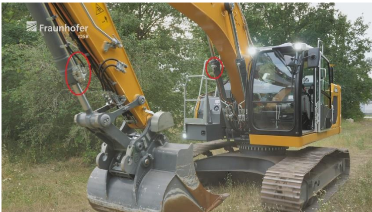
Abbildung 1: Autonomer Bagger mit Hydraulikdrucksensoren und geschätzte Kraft am Endeffektor
