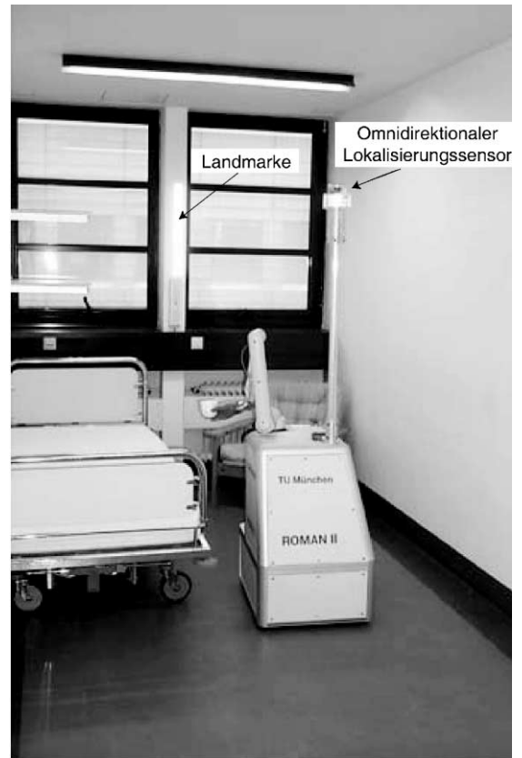
Bild 6: Experiment zur Lokalisierung im Falle relativer Winkelmessungen: Der mobile Serviceroboter ROMAN II in seiner Einsatzumgebung.
