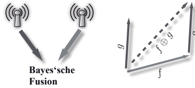
Abbildung 11.1: Die Informationsfusion von zwei Sensoren (linke Seite) nach der Bayes Formel kann als Addition in einem Vektorraum aufgefasst werden (rechte Seite). Die Log-Ratio-Information der fusionierten Dichte f \oplus g ist niemals größer als die Log-Ratio-Information der Teildichten f und g .
